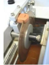
La muestra, denominada lámina delgada, consiste en la preparación de una sección transversal muy fina de la cerámica, utilizando como soporte un porta de vidrio. La sección así obtenida se adhiere al porta mediante un adhesivo.
